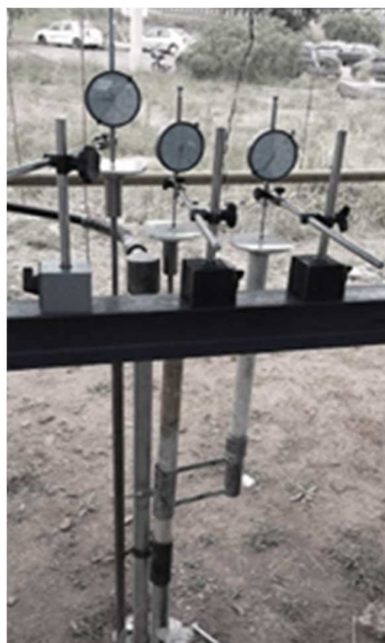
Figura 4. Relógios comparadores utilizados para medir os deslocamentos do segmento inferior, fuste e topo da estaca, ordenados da esquerda para direita.
